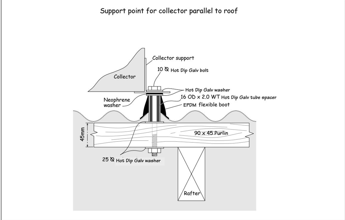
**Figure 16:** Stud fixing
